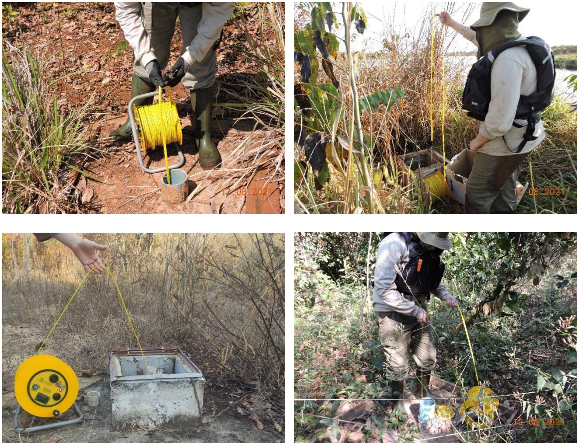
Figura 5. Medição dos poços do Programa de Monitoramento d'Água Subterrânea: Nível d'Água da PCH Bandeirante, Chapadão do Sul, MS. Agosto de 2021.
