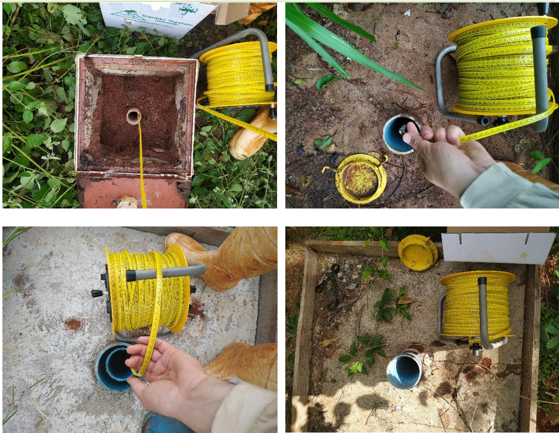
Figura 4. Medição dos poços do Programa de Monitoramento de Água Subterrânea: Nível d'Água da PCH Bandeirante, Chapadão do Sul, MS. Fevereiro de 2021.
