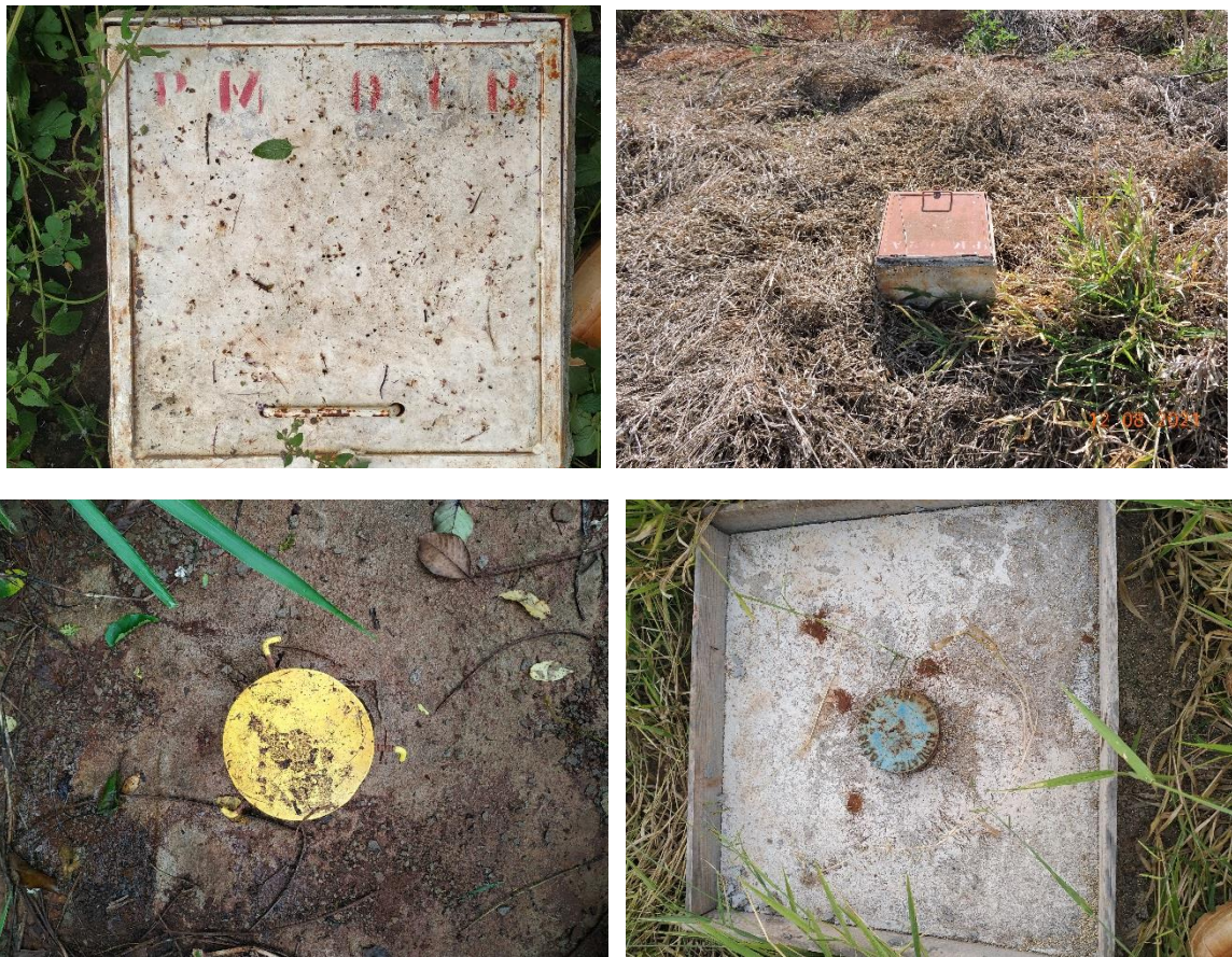
Figura 3. Pontos de Monitoramento do Programa de Monitoramento de Água Subterrânea: Nível d'Água da PCH Bandeirante, Chapadão do Sul, MS.
